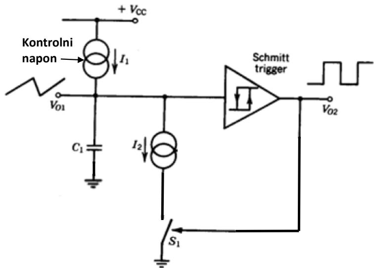
Naponom kontrolisani oscilator sa uzemljenim kondenzatorom funkcioniše na istom principu kao i relaksacioni oscilator koji sadrži uzemljeni kondenzator. Jedina razlika je da se u ovom slučaju koriste naponom kontrolisani strujni izvori.
