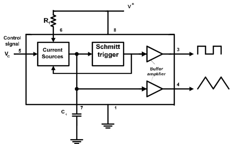
Integrисано коло NE566 је напоном контролисани осцилатор. Ово коло генерише сигнал правougаоног и trougaonog talasnog oblika. Да би се укинуо утицај потрошача на рад кола уводе се два напонска бифера. Бифер прикључен на излаз Шмитовог кола генерише правougаони таласни облик сигнала. Други бифер који је прикључен на кондензатор генерише trouгаoni таласни облик сигнала.
