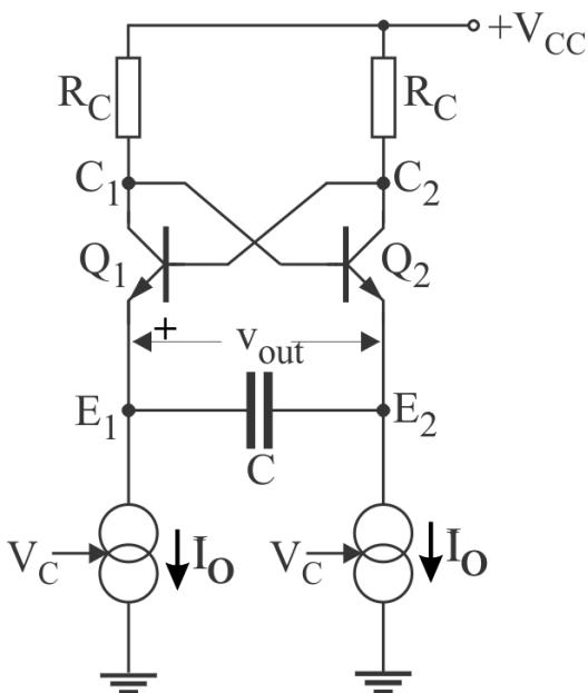
Dok vodi tranzistor Q1 struja kroz kondenzator odgovaraće struji kroz desni strujni generator. Napon na kondenzatoru će linearno da raste (za usvojeni smer merenja) sve dok napon između baze i emitora tranzistora Q2, koji je u zakočenju ne dostigne prag provođenja  $V_\gamma$ .
