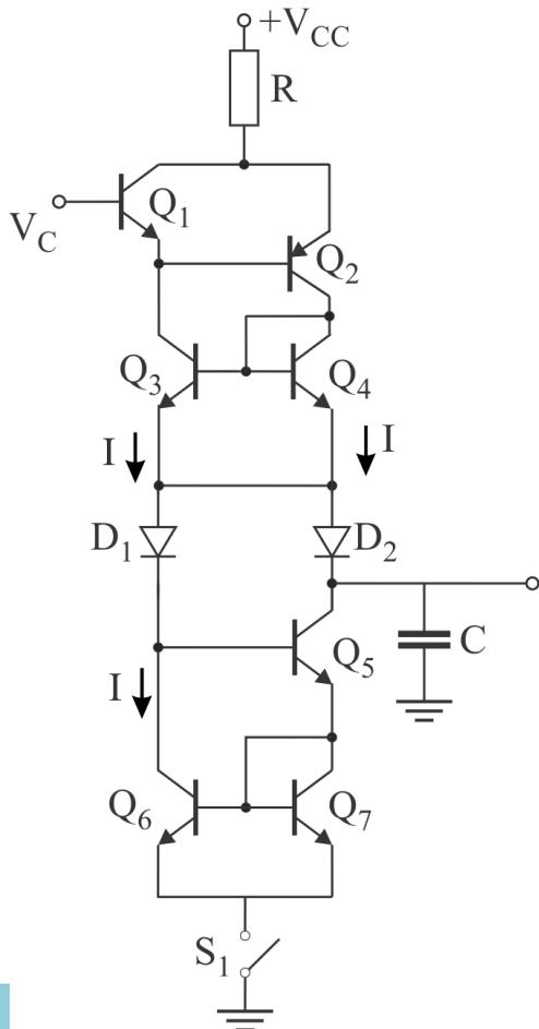
Diode  $D_1$  i  $D_2$  imaju ulogu prekidača. Kada je prekidač  $S_1$  otvoren ne teče struja kroz donji strujni generator i dioda  $D_1$  ne vodi. Kroz  $D_2$  teče struja koja utiče u kondenzator i linearno povećava napon.
