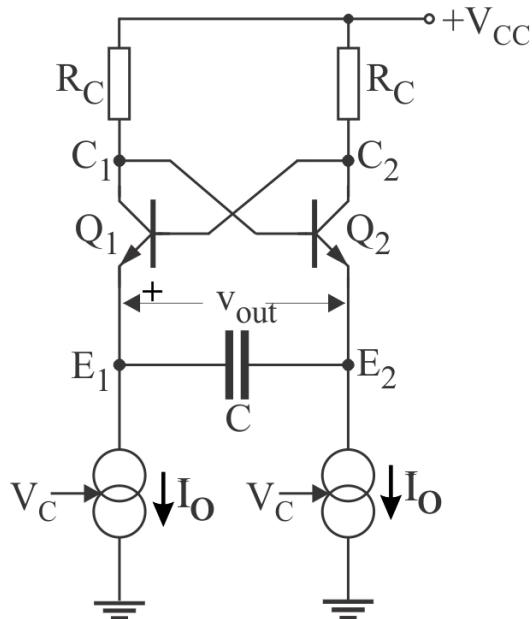
Opisano kolo je jedno od potkola u integrisanom kolu NE560. Osnove osobine ovog kola su regenerativna povratna sprega i strujni generator koji napaja kondenzator. Ovaj koncept koristi se i u integranim generatorima funkcija. Kod njih se sinusni talasni oblik dobija tako što se napon na krajevima kondenzatora dovodi na ulaz diferencijalnog pojačavača. Na taj način se približno od trougaonog talasnog oblika dobija aproksimacija sinusnog talasnog oblika.
